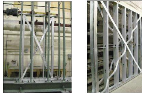
รูปที่ 5 typical strap-braced wall specimen ติดตั้งบน rig สำหรับการทดสอบ cyclic performance (ซ้าย) และ การเกิด yielding ใน strap-braced หลังจากการทดสอบ (ขวา)
