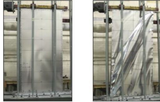
รูปที่ 4 Steel sheet Sheathing Shear wall ในการทดสอบ cyclic performance (ซ้าย) และ การเกิดความเสียหายแบบ Shear buckling ในระหว่างการทดสอบ (ขวา)
